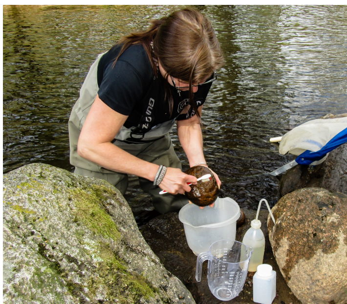
Figur 23. Vid kiselalgsprovtagning hämtas minst fem slumpvis valda stenar från en representativ sträcka av vattendraget, varefter kiselalger och övrig påväxt borstas av från stenarna med en ren tandborste. Materialet sköljs av och samlas upp i en vanna/bunke. Det blandas noga och hålls sedan i burkar, som förvaras svalt och mörkt. Efter att materialet i burken har sedimenterat hålls större delen av vätskan av och ersätts med etanol. Om stenar inte finns på lokalen läggs delar av friska vattenväxter i en burk eller bunke med åvatten. Burken skakas kraftigt (alternativt tvättas växtdelarna av för hand), så att kiselalger och annan påväxt lossnar, varefter vattenväxterna kramas ur och avlägsnas. (foto: Medins Havs- och Vattenkonsulter AB).
